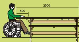
Plateau déplaçable, modèle adaptable pour accueillir une personne à mobilité réduite à l'extrémité de la table
